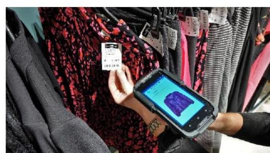
订单根据合理、有效的路线分批收集,同时兼顾品牌和部门等因素。Zwijgers解释说:“下订单后,它们会根据商店和运输方式按顺序自动拆分。”然后借助移动数据终端,将商品收集到车间的拣选小车上。员工看到图片,走到相应的位置,扫描相关的货品,然后会立即看到下一件要分拣的货品。”然后把收集到的货品送到运输部门。Van Tilburg 将单线订单和多线订单区别开来。单线订单直接包装和运输,而多线订单首先分拣,并仅在完成整个订单的情况下装配和包装。扫描包装台上的货品时,系统会自动生成正确的装箱单、退货单和运输标签。
